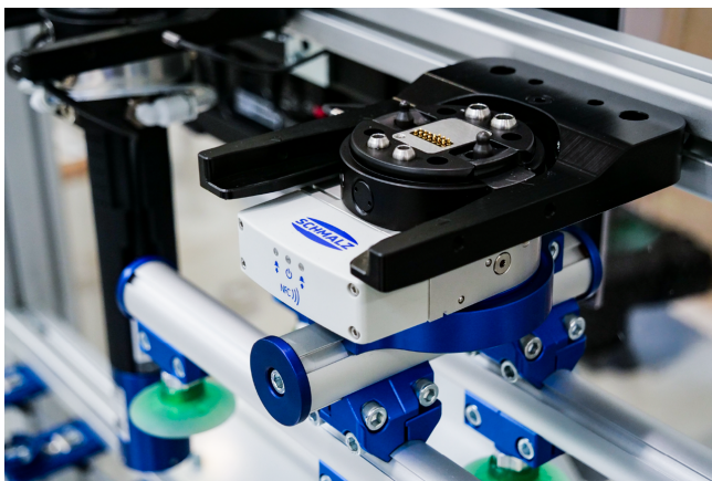
Generador de vacío neumático RECB MATCH manipulando envases de cartón
